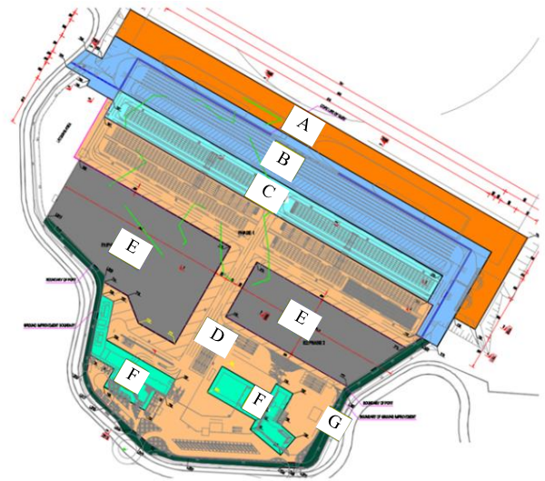
图 18 振冲碎石桩施工区域分布图
