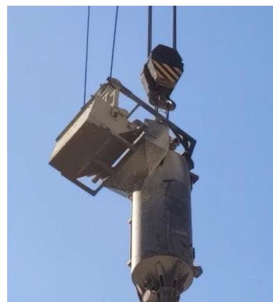
图 13 卷扬翻转式料斗 Fig. 13 Turn-over hopper
