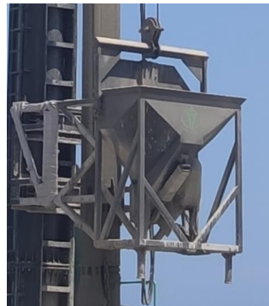
图 12 滑轨滑槽式料斗 Fig. 12 Slide-style hopper
