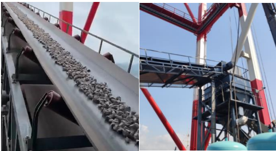
图 23 可实现全自动控制的上料皮带机和料斗
