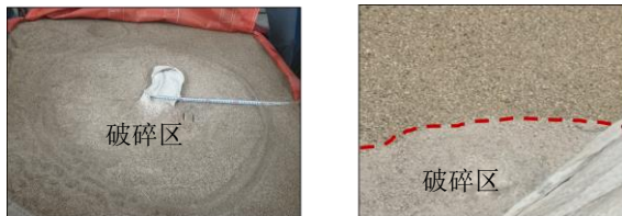
(a) 干砂颗粒破碎整体与局部图像
