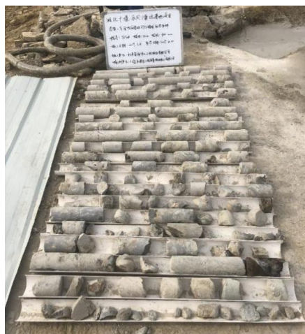
图 13 DJP 水泥土桩取芯效果图
