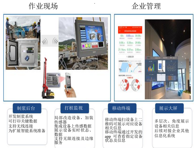
图2 桩机施工智能化系统架构图
