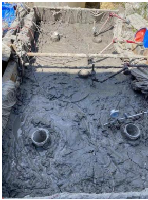
图 1 竖向电渗模型试验装置
