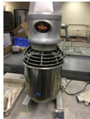
(a) 水泥土搅拌
