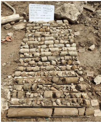
图 6 4-SZ1 号水泥土桩芯样照片
