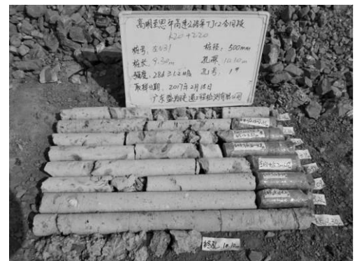
图 4 搅拌桩施工质量抽芯检测照片（第 1 批）
