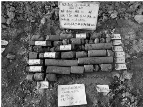
图5 搅拌桩施工质量抽芯检测照片(第2批)
