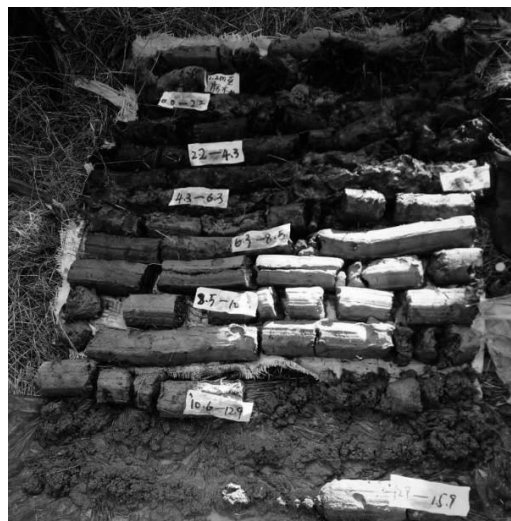
图 3 施工前补勘抽样照片
