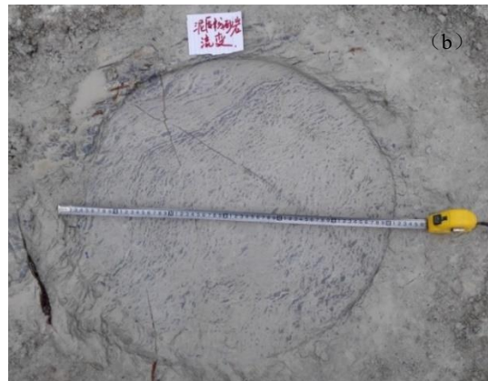
2号试验点: 泥质粉砂岩, 青灰色, 层理发育, 缓倾角, 岩层产状 134^{\circ} \angle 18^{\circ} 。发育 1 条陡倾角长大裂隙, 贯穿点面, 裂隙面上有红褐色充填。
