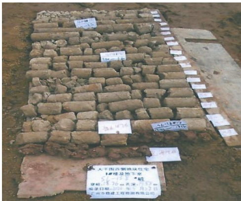
图6 水泥土墙抽芯芯样
