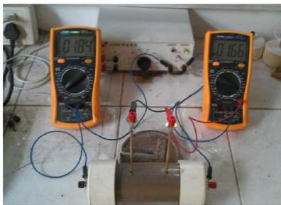
图 2 四电极电阻率测试设备
