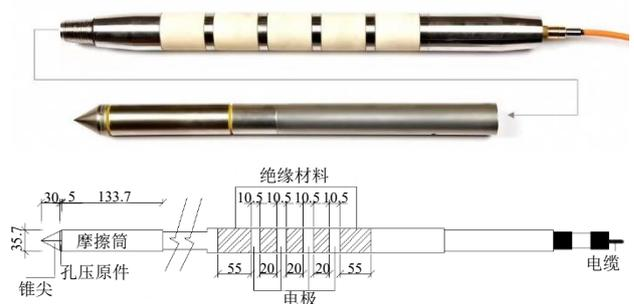
图 3 电阻率 CPT 探头
