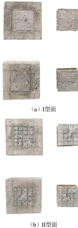
图5 I型面与II型面黏结抗拉试件拉断面
