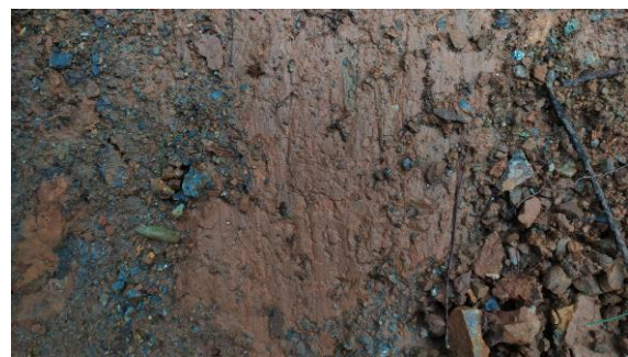
图8 滑面泥砂质充填物中的擦痕
