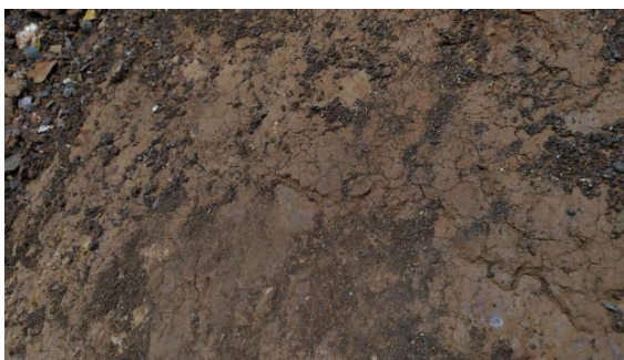
图7 滑面泥质充填物
