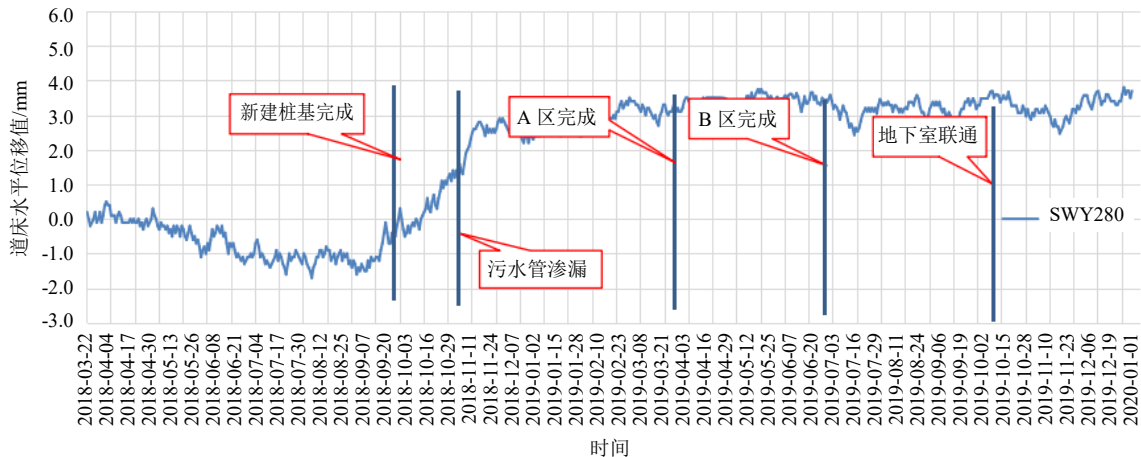
图 15 上行线典型监测断面 SWY280 道床水平位移累计变化量沿时程变化曲线
