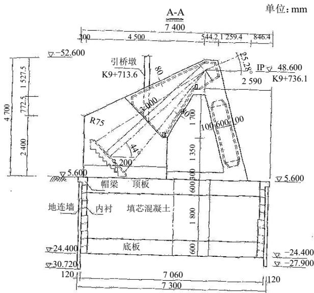
图 15 黄浦大桥锚碇基础
