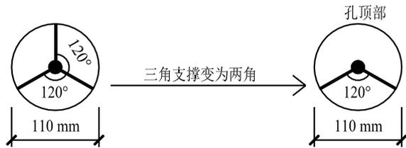
图6 土钉定位筋优化图
