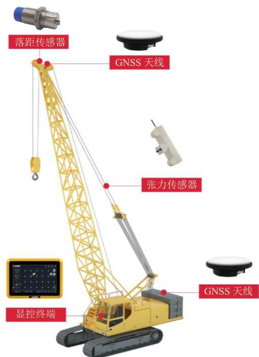
图 1 强夯施工质量智能化监测系统硬件
