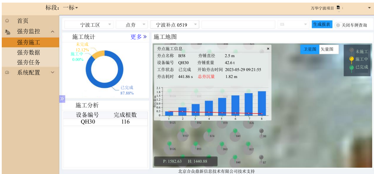
图 8 数字化施工云平台
