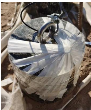
图5 落锤加速度传感器安装方式
