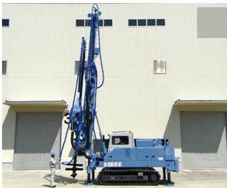
图1 GI-130C搅拌桩机照片
