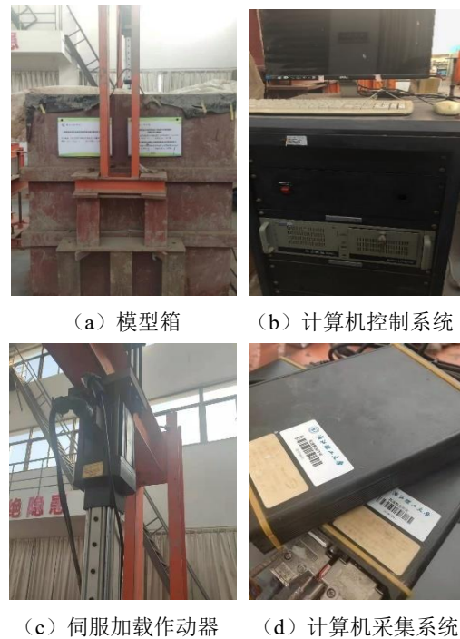
图1 岩土工程模型试验系统
