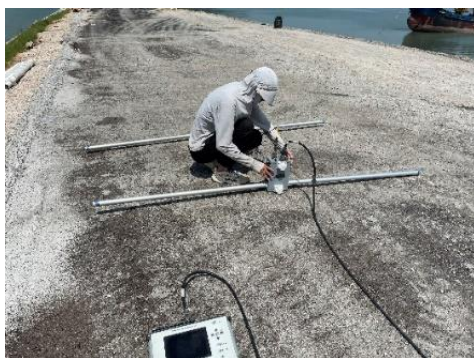
图3 地质雷达现场测试图
