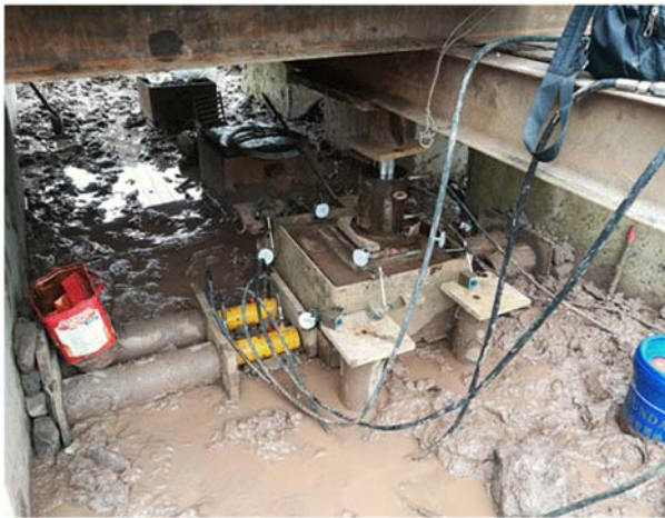
图 3 原位直剪试验设备安装图
