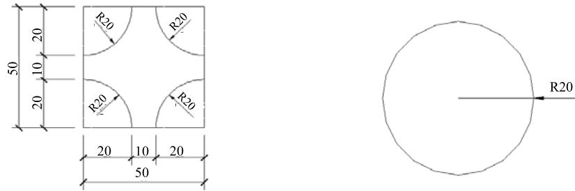
图 3 X 形桩与圆形桩截面图（单位：mm）
