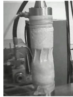
图 2 动三轴试验样品破坏形态
