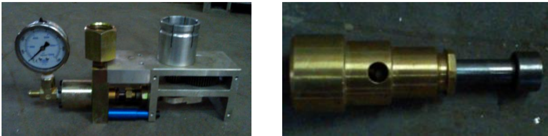
图2 灌浆泵活塞筒及活塞杆结构图
