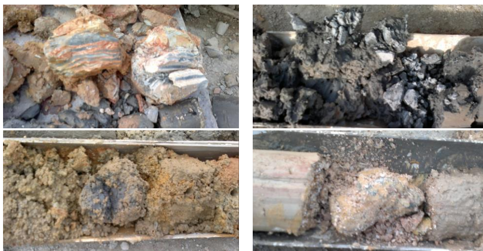
图5 袖阀管注浆检查孔局部特写
