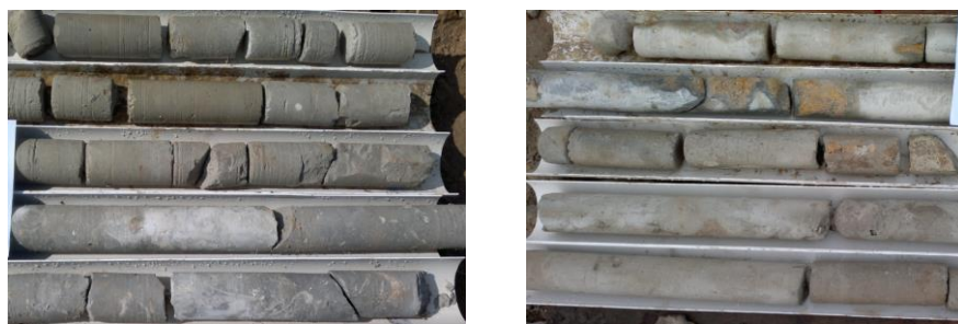
图 4 高压旋喷注浆检查孔局部特写
