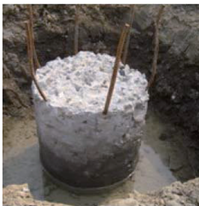
图3 浆固散体材料桩桩头开挖实物图
