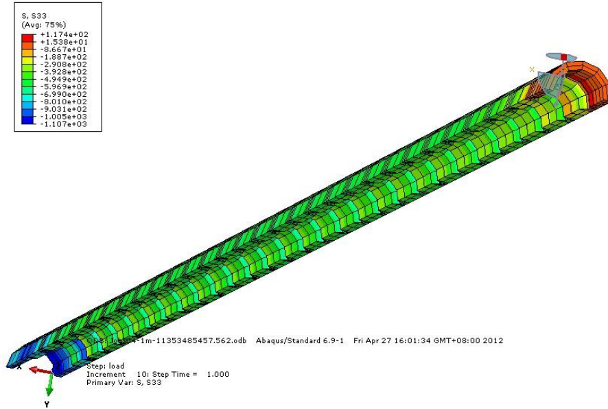
图 17 Z1 水泥土竖向应力分布云图
