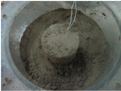
图7 室内模型试验碳化搅拌桩开挖照片
