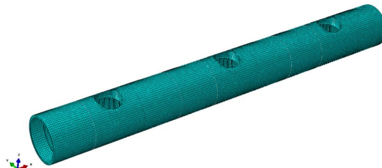
图 5 新建特殊段隧道开口有限元模型
