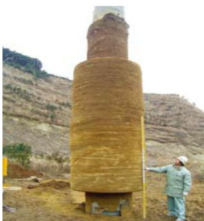
图 5 扩底固化部形成状况确认 (KON、OGURA 等)
