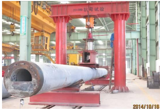
图 3 现场抗弯试验图
