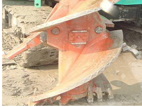
图1 液压扩大翼打开状态
