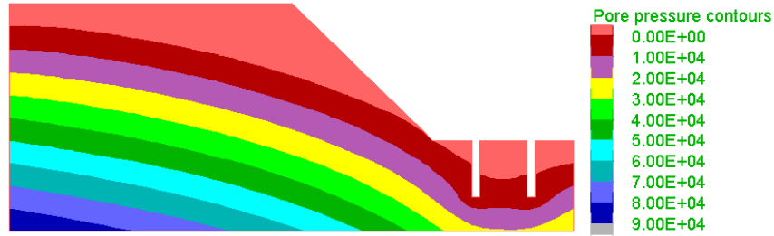
图 2 基坑降水孔隙水压力分布图
