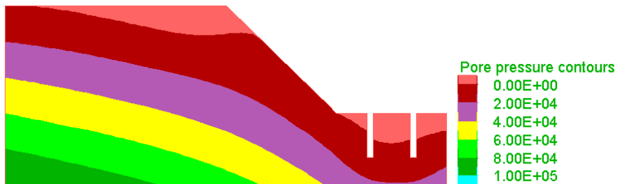
图 8 降雨 33.3h 后孔隙水压力分布图
