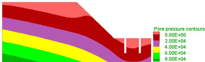
图 6 降雨 10.0h 后孔隙水压力分布图
