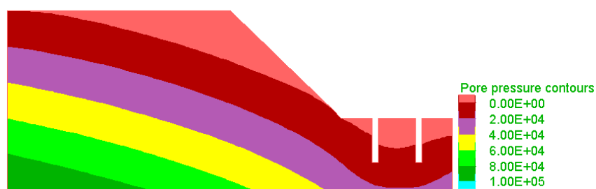
图10 护坡情况下孔隙水压力分布图
