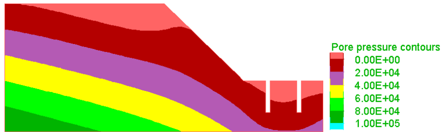
图 7 降雨 16.7h 后孔隙水压力分布图
