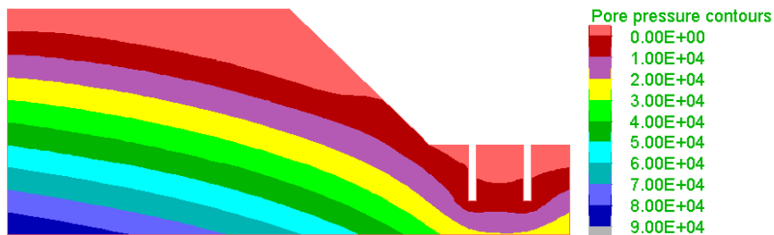
图 4 降雨 2.8h 后孔隙水压力分布图
