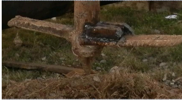
图 11 C区搅拌设备的喷浆口及叶片
