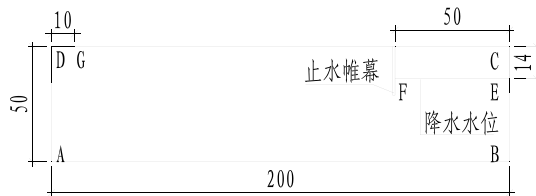
图 1 计算模型截面尺寸图 (单位: 米)
