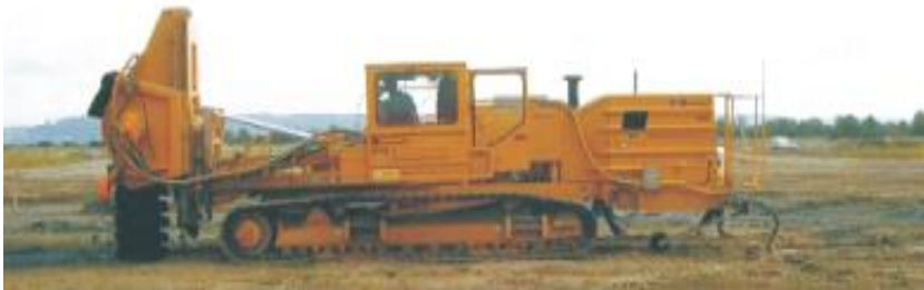
图4 (b) 沟槽搅拌系统 (Bachy Soletanche, 2005)
