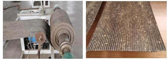
图 3 环保型秸秆排水板板芯图
