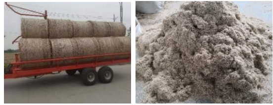
图 2 秸秆排水板秸秆原材料及粉碎后短绒纤维图
