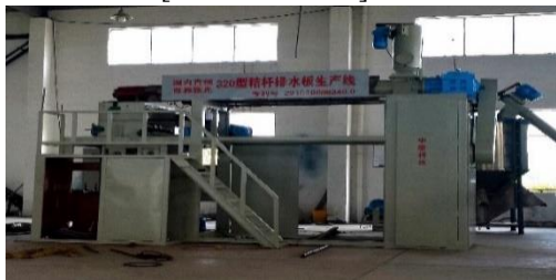
图 1 320 型秸秆排水板生产线设备现场图
