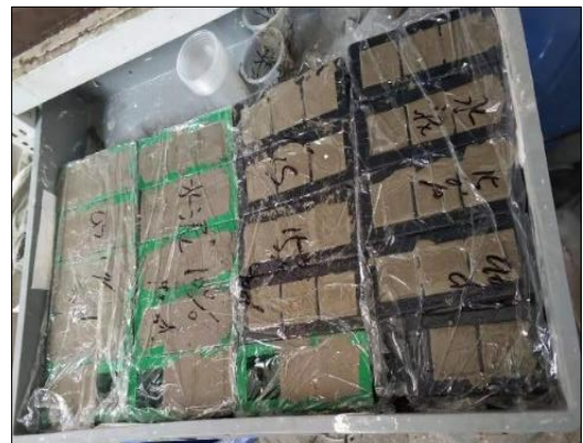
图1 封膜的固化土试件
