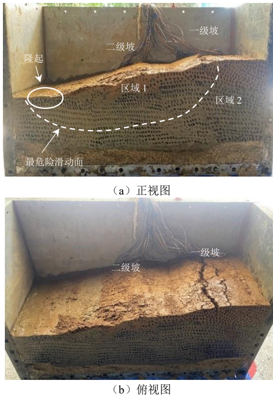
图3 河堤的破坏形态 Fig. 3 Failure mode of riverbank
