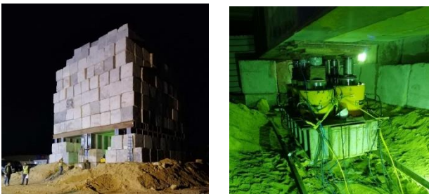
图 3 现场静载试验
