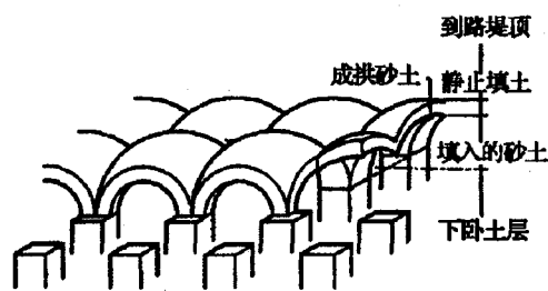
图4 Hewlett 和 Randolph(1988)提出的土拱模型
