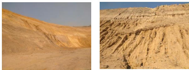
图2 降雨前(左)后(右)边坡面对比
