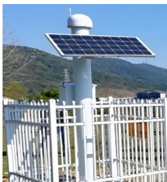
(b) 水平位移监测设备
