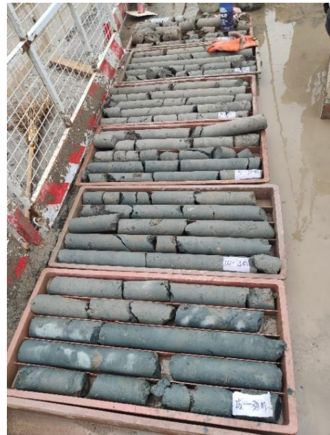
图 16 帷幕桩抽芯情况
