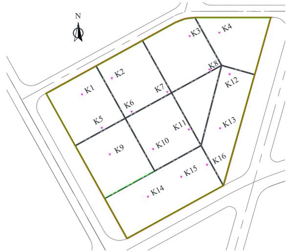
图 12 孔隙水压力监测点布置图
