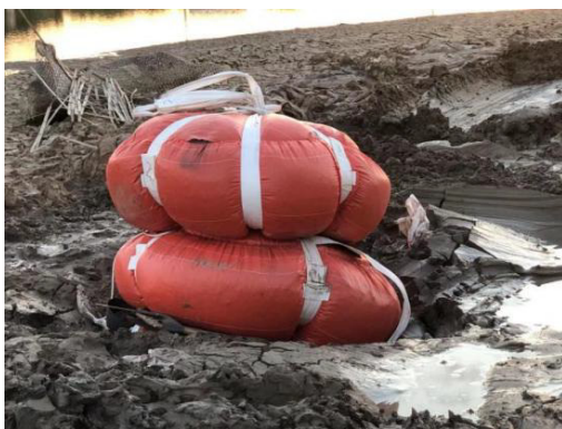
图 11 试验地固件在第二级荷载下倾覆破坏
