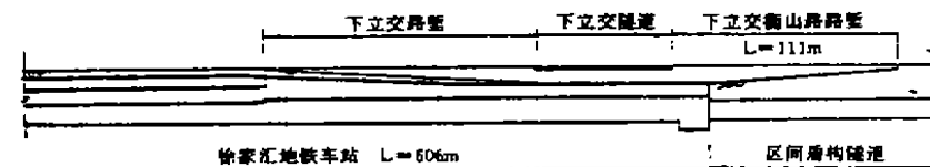
图1 徐家汇下立交工程纵剖面示意图
