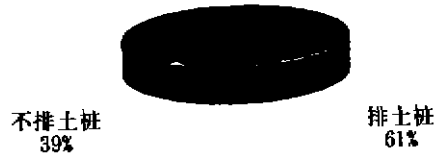
1997年欧洲排土、不排土桩的选用情况
