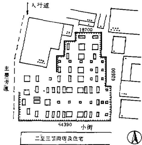
图1 基坑支护平面图
