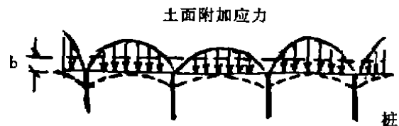
图 6 疏桩基础中桩荷载引起的土面变形与基底附加应力
