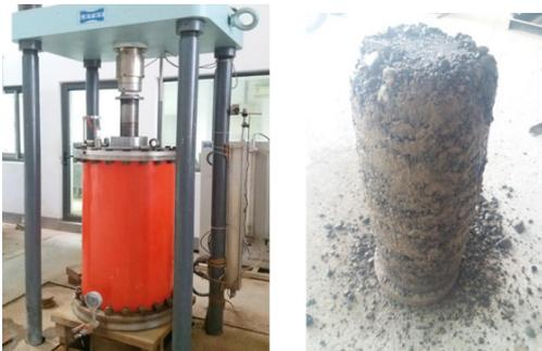
图6 卵砾石混合料大三轴试验
