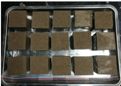
图5 脱模后的水泥土立方体试样
