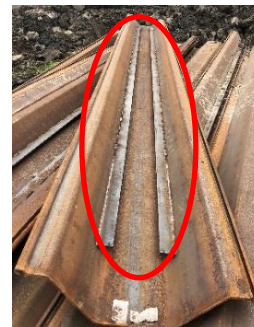
图 3 帽型 H 型钢嵌合型组合桩的嵌合装置
