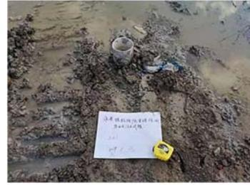
图 11 TRD 墙体现场降水头注水试验
