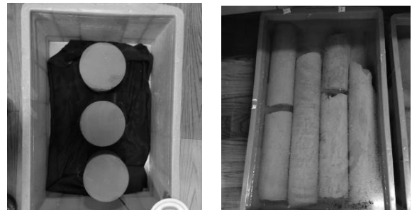
图3 多向切割搅拌桩芯样
